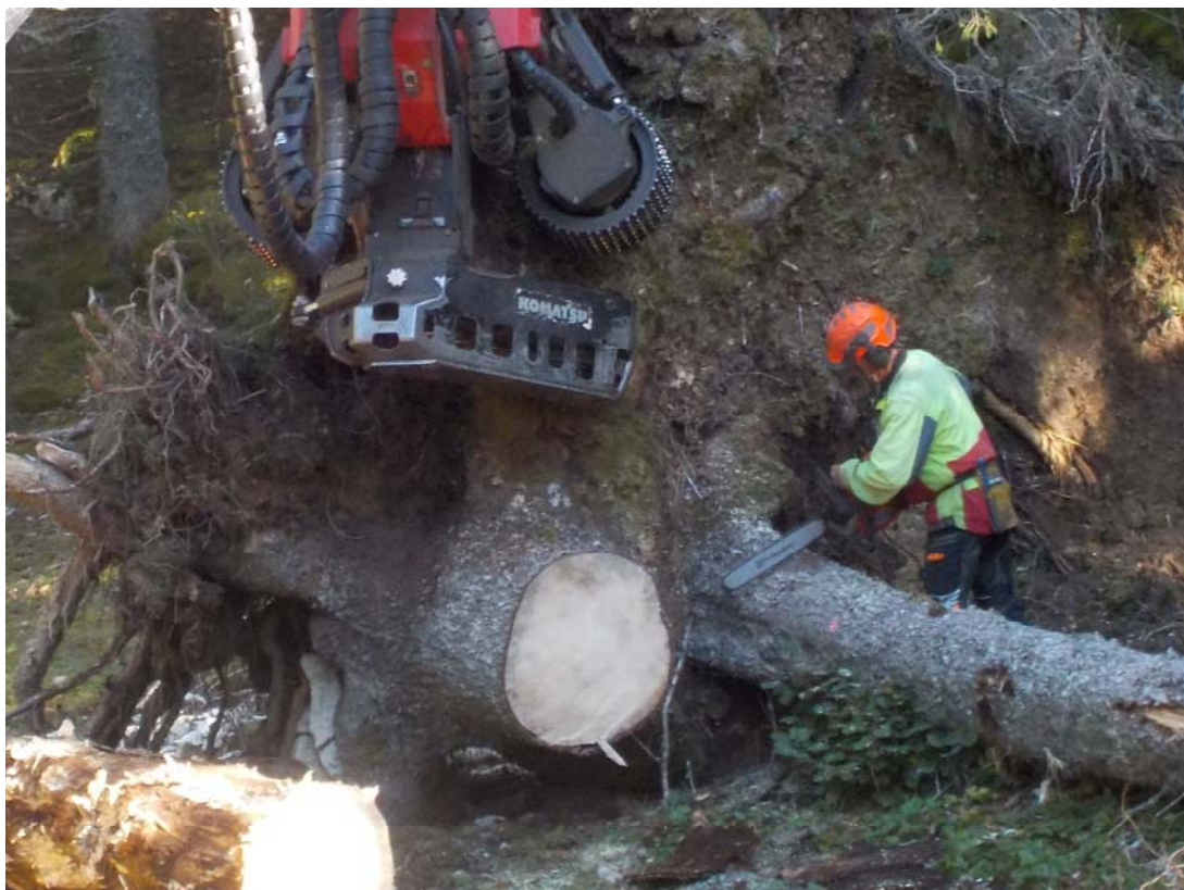
La tête de coupe soutient la « motte », monstrueuse, pendant que le bûcheron tronçonne.
